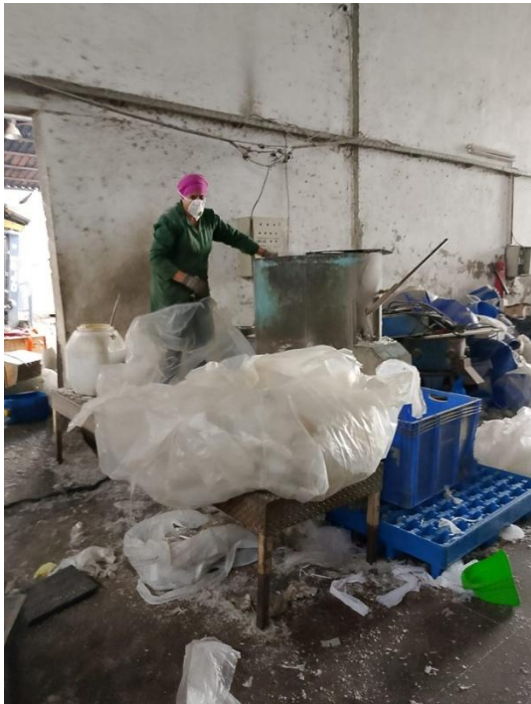
Figure 1. Ouvrière introduisant les plastiques triés dans une machine de granulage au sein de l'usine de recyclage AFREC (El Mghira, Grand Tunis)
